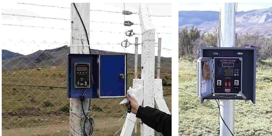
**Figura 1.2 Estación NRG Wind Explorer UNPA-SPSE Río Turbio (2002) y (der.) Estación NRG 9200 en Lago Posadas, Santa Cruz (2001)**
