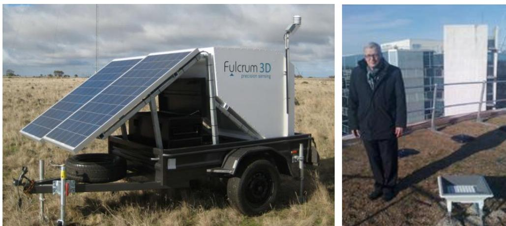
Figura 3.17 (izq) SODAR Fulcrum 3D fabricado en Australia, y (der.) SODAR RemTech PA-XS, producido en Francia.
