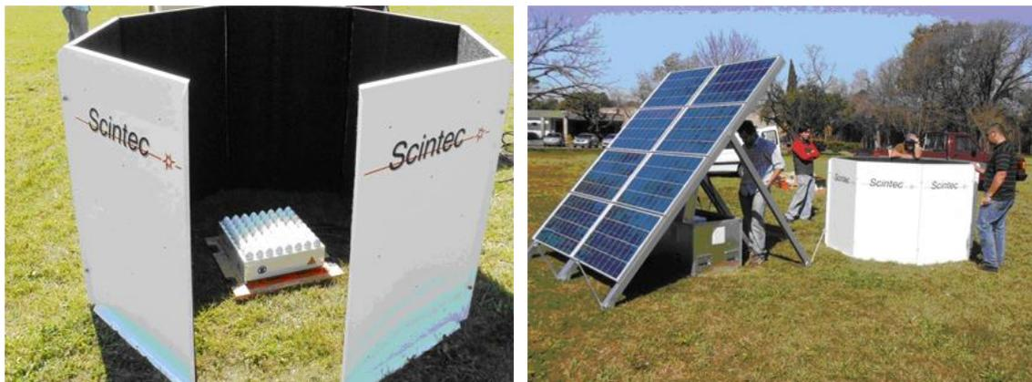
Figura 3.14 Equipos SODAR Scintec de matriz de antenas (*Phased array* adquiridos por ENARSA en 2011).
