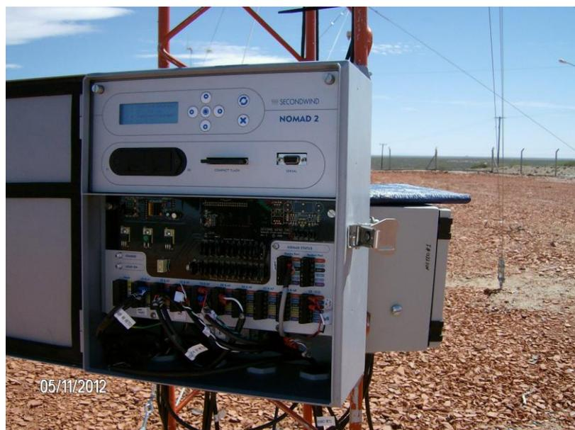
Figura 6.21 Secondwind Nomad2 de referencia junto a METEO en Campo de Pruebas INTI Cutral-Có
