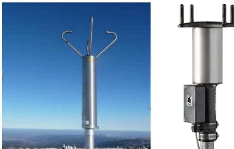
**Figura 3.12 (izq) Anemómetro 2D METEK uSonic2 Heavy Duty, 55W (der.) Anemómetro 2D R M Young 85000**
